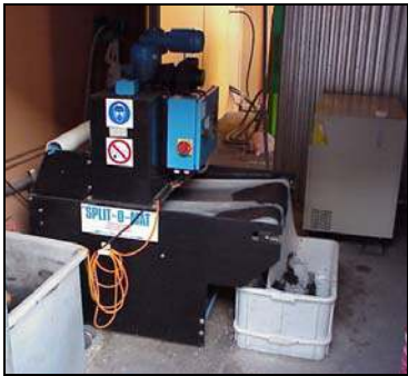
Depuradora por floculación
